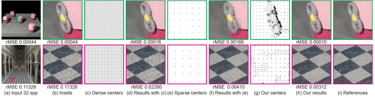
上图中 (a) 表示输入图像，(b) 表示输入图像某区域放大后的结果。(c) 和 (d) 表示使用稠密的预测中心生成的预测结果，(e) 和 (f) 表示稀疏的均匀预测中心预测的结果，(g) 和 (h) 表示本算法的稀疏非均匀预测中心得到的结果，可以看到，该算法自适应地选择预测像素中心的位置，且误差 (rMSE) 更小。
