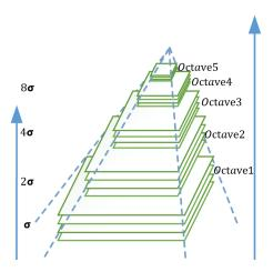
其中 Octave 表示产生的图像组数,每组图像有 Interval 个图像 (表示为图像层),因此一组 图像有多个层。每层图像都是该组初始图像(该组最底层的图像)用不同高斯核做高斯卷积得到 不同尺度得到的。每组图像的初始图像是上一组图像中的某层图像(比如我们先假定为上一组最 底层的图像)进行隔点采样得到的。)我们先不要管上图中左边的 2°σ 这些系数是怎么来的,后 面会讲。
