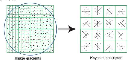
上图表示的是生成的描述子周边 4×4 的区域的示意图,这是论文 [2] 给出的建议。每个区域中的梯度方向的统计中,高斯加权是以整个大区域的中心为高斯核中心的,而不是每个区域自己的中心为高斯核中心。把每个子区域所有样本点的梯度加权求方向,就得到了上图右边的表示。
