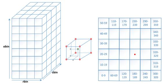
在左图中,比如我们要计算  $d \times d \times n$  的区域中,第 3 行 2 列 (索引为 (2,1)) 第 5 个方向 bin 中的值,即左图红点格子里 obin 方向第 6 个格子 (索引为 5) 里的值: ((2+1)\*(4+2)+1+1)\*10+5=205。
