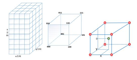
首先是双线性插值,每一个点对离它最近的 4 个子区域的直方图生成都会有影响;同时角度也要进行线性插值,因此可以理解为整体是三线性插值。要插值到周边的 8 个矩阵元素上并不容易,我们根据上图右边来理解一下,我们设 3 维矩阵中的八个元素分别表示右图中的红点,当前采样到的梯度像素位置为右图中的绿点(注意这里的  $(x,y,\theta)$  只是相对位置,与前面所述的位置没有什么关系),要把绿点的数值贡献分配到周边的 8 个点上。我们会在本小节后面介绍像素区域与像素离散点之间的关系。
