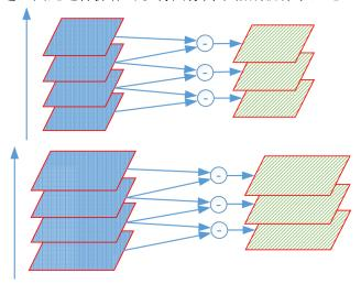
我们再重复一遍,每层图像都是该组初始图像(该组最底层的图像)用不同高斯核做高斯卷 积得到不同尺度得到的。每组图像的初始图像是上一组图像某层进行隔点采样(以 2 为因子下采 样)得到的,然后再通过高斯模糊得到该组其他层的图像。
