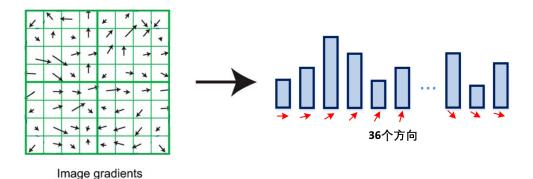
之后我们还需要对直方图进行一下平滑,防止某个方向因为噪声干扰等原因突变,可以使用简单的高斯卷积来平滑,也可以使用其他方法,等到程序解读中我们再介绍 OpenCV 程序使用的平滑方法。
