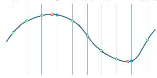
如上图,很可能出现的情况是:检测出的极值点为蓝色点,但是实际为红色点,因此就需要在离散点之间插值来得到连续空间的极值。在 1999 年的论文 [1] 时并没有进行精准定位,只是找到蓝色点作为极值位置即可,在 2002 年的论文 [4] 中提出可以拟合三维二次函数来更精确地定位关键点位置与尺度。
