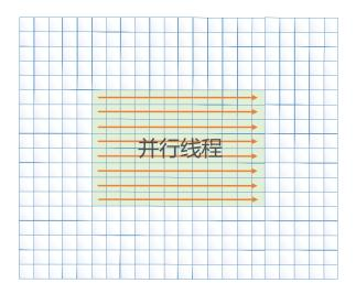
**补充** 5.2 **(TLS 的好处)** 上面的程序里,不同的线程都是为了计算一张 DOG 图像上的关键点位置,如果保存到同一个内存区,就得用互斥锁来防止数据存储冲突,这样会降低效率。因此使用 TLS 管理每个线程的局部内存区则会加快速度(相应地,也会增加内存消耗,因为需要提前安排可用内存)。
