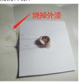
将电磁铁固定到瓶子底座,然后让铜丝圈套在磁铁上,将瓶边粘在纸上,最好保证线圈悬空(如下图中最右边的图)。
