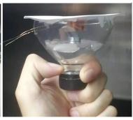
因为小耳机线里面的电线实在是细,所以这里我使用双耳机接头,一个接头连接电脑音频接口,一个接头将地线和其中一个声道接上线圈两个引脚。
