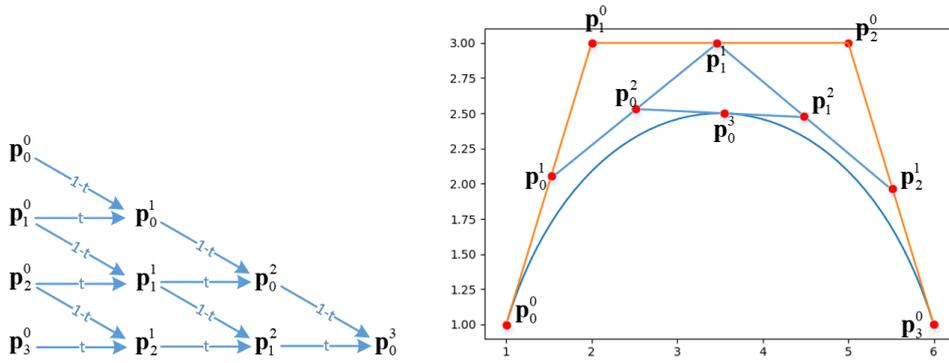
细分也分为两种，一种是逼近型细分，另一种是插值型细分。对于逼近型，不要求细分后的曲线正好能插值到控制点，而插值型细分则要求曲线能插值到控制点上。
