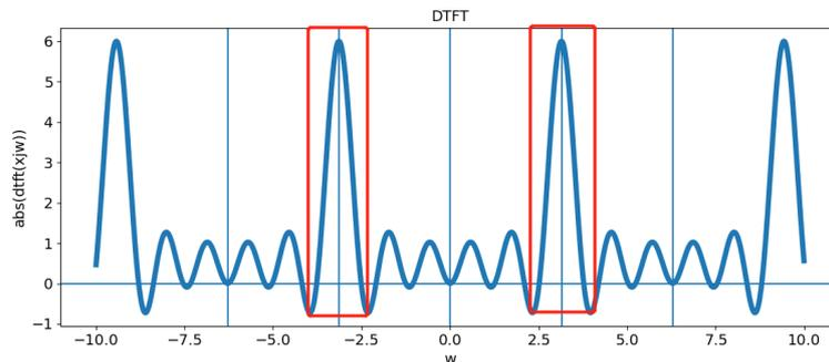
上面的两幅图中，有的用红色框标示了出来，表示成分比较高的区域，蓝色框表示成分比较低的区域。可以看到，第一个信号和第二个信号因为是方形信号，所以低频占主要成分；第三个信号是高频信号，高频占主要成分，因此，离散时间傅里叶变换中，靠近  $\pi$  的整数倍的地方表示高频，靠近  $2\pi$  的整数倍的地方表示低频。
