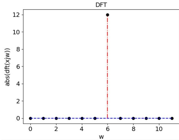
由此可知，离散傅里叶变换的结果中，靠近中间的属于高频成分，靠近两边的属于低频成分。如果是一个方波信号：
