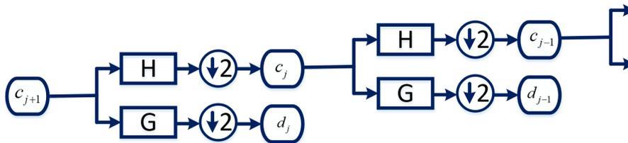
这里包含了一个下采样操作。可能有些人会问，我们分解以后的信号长度不是已经减半了吗？其实这里的滤波和下采样在前面的介绍中是合为一体的，前面的公式已经包含了滤波和下采样过程。
