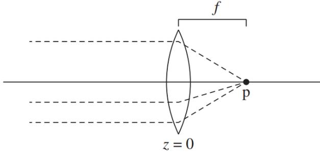
要聚焦某个平面上的点，聚焦面离透镜的距离就有不同：
