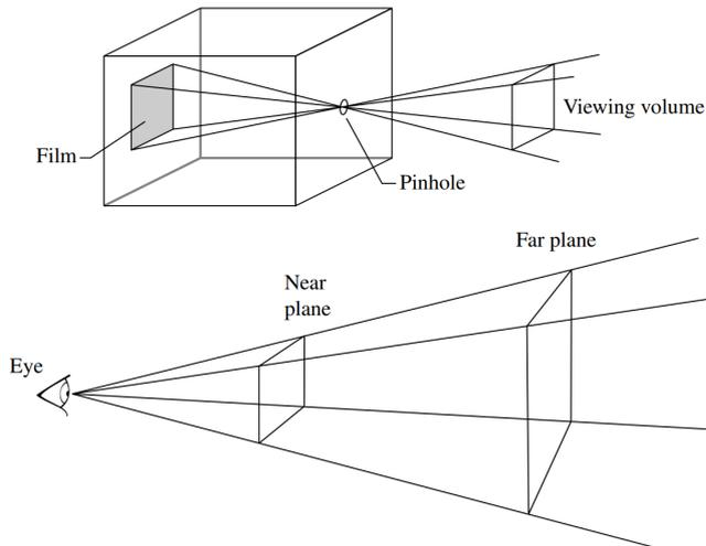
上图中的上面表示的是针孔相机模型，下图是计算机图形学里常用的针孔相机表示。但是这种相机与我们真实的相机有很大不同，比如真实的相机存在离焦模糊，而针孔相机在所有区域都非常清晰。另外真实相机中，光通过镜头系统以后的分布也不同于针孔相机。但真实相机的离焦模糊现象我们是模拟出来的，而且真实感相机实在是有些复杂，而且一般用不到，因此我们只学习针孔相机。学会并移植好针孔相机以后，其他的相机种类并不复杂。
