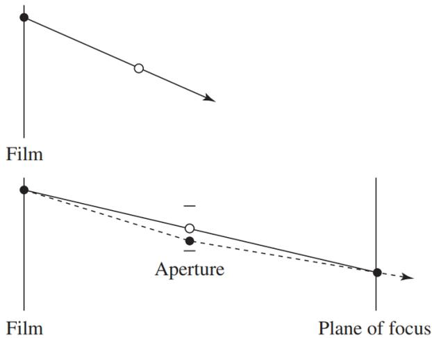
上图的上面表示的是我们以前的针孔相机，都是从胶片上发出光线。而上图的下面模拟的薄镜头相机，首先选择一个光圈，然后再光圈上选择中心和另外一个点，我们假设 Film 上通过这两个点的 Ray 正好聚焦在 Film 上，因此计算这两个 Ray 在远平面的交点即可。之后再根据公式就能计算出我们要聚焦的平面的距离了。实际操作中，我们为每条光线在透镜上采样一个点，然后我们计算穿过透镜中心的光线（对应于针孔模型）和与焦点平面相交的点（实线）。我们知道，无论镜头样本的位置如何，焦点平面上的所有物体都必须对焦。因此，对应于镜头位置样本（虚线）的光线由从镜头样本点开始并通过聚焦平面上的计算交点的光线给出。
