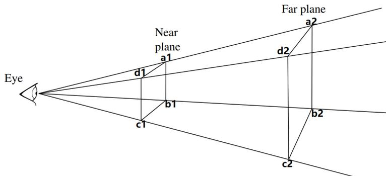
`CameraToScreen` 会把近平面上的点，也就是上图中 `a1, b1, c1, d1` 构成的面上的点的  $z$  值都变为 0，远平面上的点经过变换会变为 1。处在近平面和远平面构成的视锥体内的点经过 `CameraToScreen` 变换以后会被压缩到 `screen` 空间的范围内（该范围不是严格的  $[-1, 1]$ ）。所以透视相机和正交相机的 `CameraToScreen` 函数对可见空间内的点变换后的坐标范围是不同的： $z$  轴都是压缩到了  $[0, 1]$ ，但是正交相机并没有压缩  $x$  和  $y$ ，而透视相机把  $x$  和  $y$  压缩到了 `screen` 之间，大家尤其需要注意这一点，关于具体的压缩过程和范围，大家可以从《三维视角投影变换与代码实战》中找到详细解释，该书已发布。
