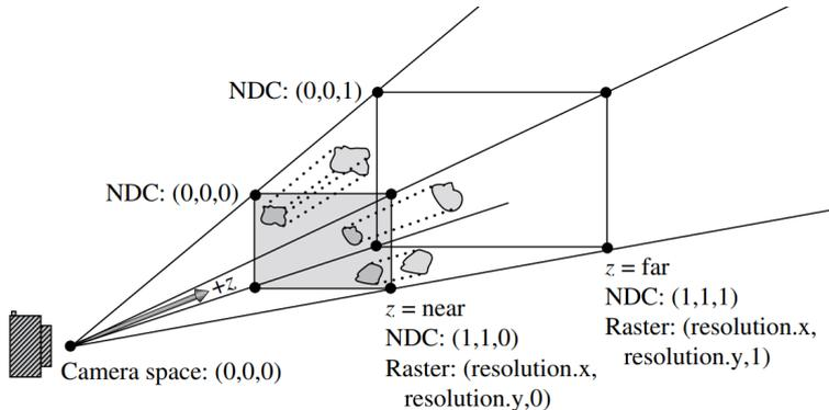
NDC 是标准设备坐标，在裁剪体内会被变换到  $(0,0,0)$  到  $(1,1,1)$  的包围盒（NDC，标准化设备坐标）里，然后再映射到光栅坐标（Raster）上。对于投射相机来说，它的输入参数相比相机基类 Camera 多了 Transform & CameraToScreen，即变换到屏幕坐标的变换，对于投射相机还有 RasterToScreen, RasterToCamera 等变换，就是从光栅坐标到屏幕再到相机坐标之间的变换，我们先简单介绍一下各个空间。
