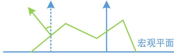
绿色箭头表示某一片微表面法向量，蓝色箭头表示宏观看到的整体法向量（比如，实际来说，在一个三角面片上通过三个顶点计算出来的法向量）。对于固定大小的微表面，微表面法向量与宏观法向量夹角越小，则投影面积越大。
