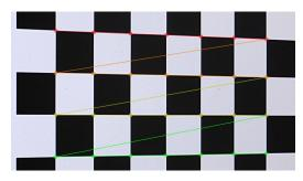
在《相机标定入门详解》中,我们已经介绍了基本的标定方法,所以也不再赘述,重投影以后得到结果(选择其中一张图,此图中相机的外参平移和旋转都是已经求解得到的,我们将角点的世界空间坐标重投影到图像上):
